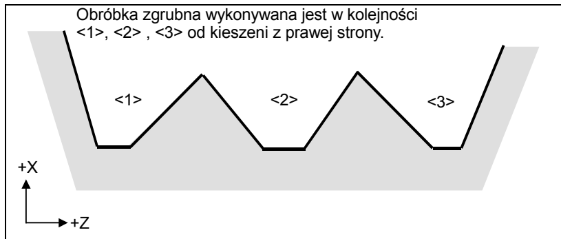
Rys. 6.4.1 (n) Kolejność obróbki zgrubnej w przypadku równomiernego wzrostu (typ II)
