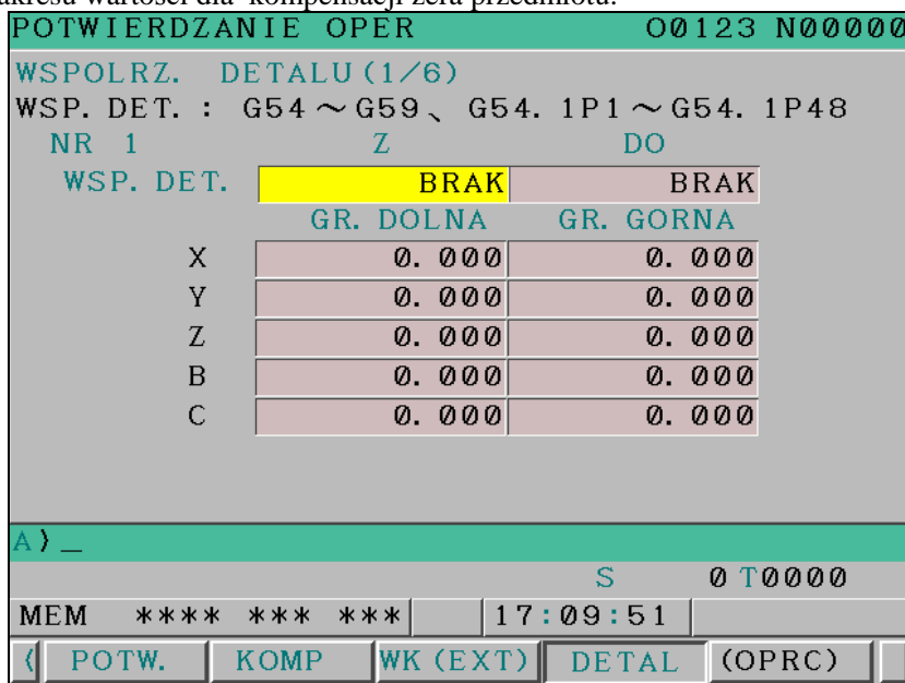
Rys. 6.5.3.3 (a) Ekran ustawiania zakresu wartości dla kompensacji układu współrzędnych przedmiotu
